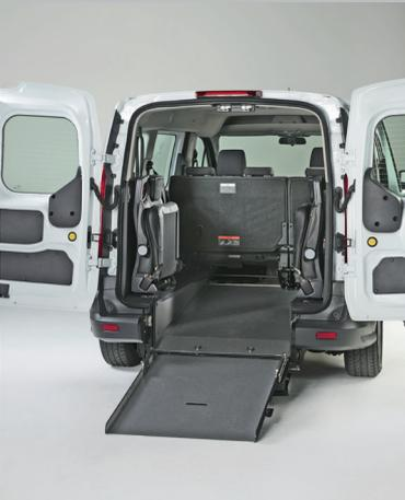
Heckausschnitt zur Aufnahme eines Rollstuhles inkl. hochklappbarer Easy-Rampe, Automatik-Schrägschultergurt, TÜV-Abnahme.
