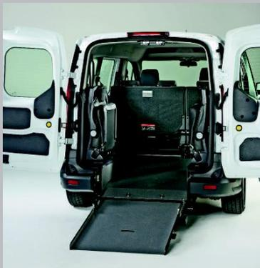
Heckausschnitt zur Aufnahme eines Rollstuhles inkl. hochklappbarer Easy-Rampe, Automatik-Schrägschultergurt, TÜV-Abnahme.
