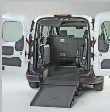
Heckausschnitt zur Aufnahme eines Rollstuhles inkl. hochklappbarer Easy-Rampe, Automatik-Schrägschultergurt, TÜV-Abnahme.
