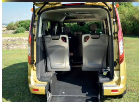
Kofferraum bei eingeklappter Rampe
