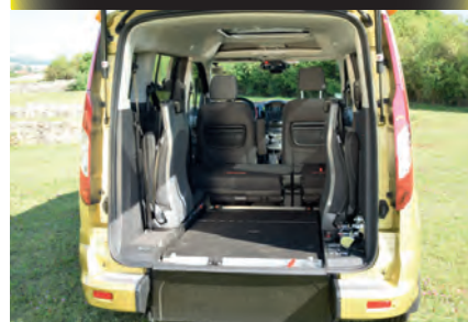
Kofferraum bei eingeklappter Rampe
